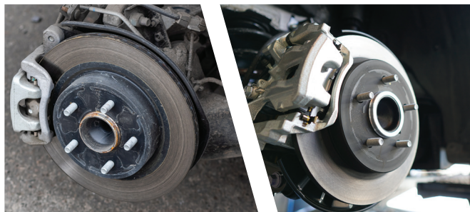
Kočnice automobila prije i nakon čišćenja
